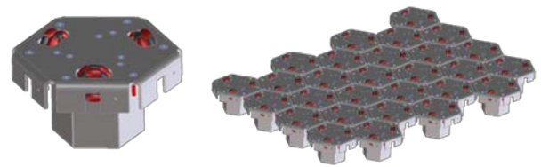
Abbildung 2: Ein Modul und die Kombination mehrerer Module zu einer Förderanlage, (eigene Darstellung)
