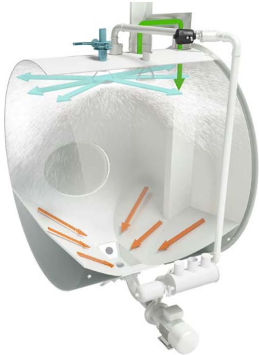
Abbildung 7: SpezialTankSystem mit Sprühbefüllung, Vertikalüberlauf und starker 35°-Bodenneigung © Herbert Kannegiesser GmbH, Vlotho
