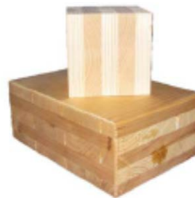
Abbildung 2: Brettsperrholz BSP, © TU München
